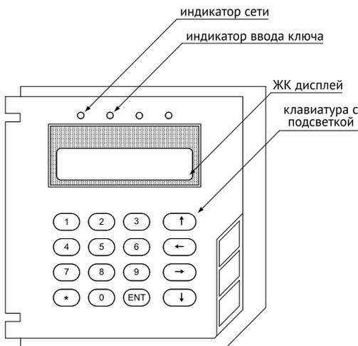
Индикатор сети в зависимости от режима работы устройства отображает состояние связи с объектовым прибором.
