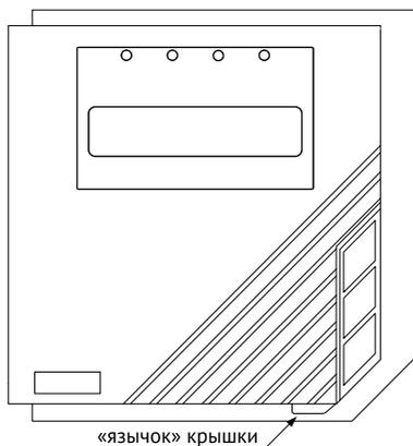
Для открытия крышки, закрывающей клавиатуру пульта, нужно потянуть за язычок крышки в правом нижнем углу.
